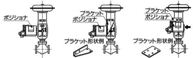
ダイヤフラム弁へ直接取付け取付け例
