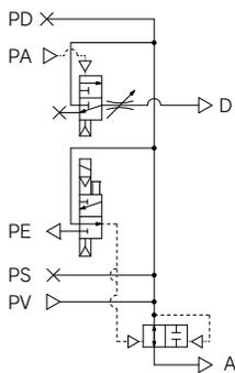
用途: 供給の制限は電気信号で行い、破壊はエア信号にて行います。供給用弁がN.O.タイプですので、停電時に、エジェクタへの供給圧力は停止することがなく、吸着状態を維持します。停電時のワークの落下防止の場合に使用します。
