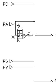
用途: 供給の制御は、外部の弁にて行い、破壊は外部からのエア信号にて行います。
