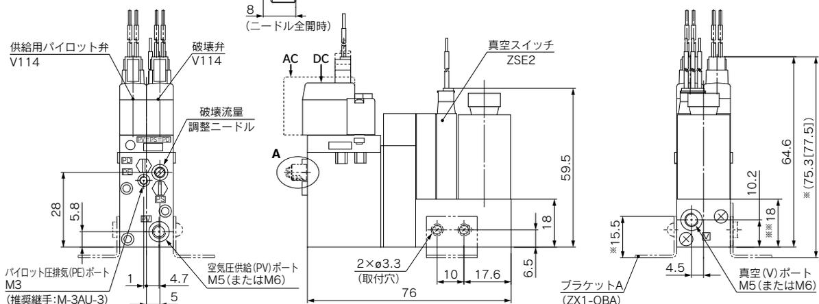
注) ※寸法はブラケットAの取付時、※※寸法はスペース1の取付時の寸法です。
