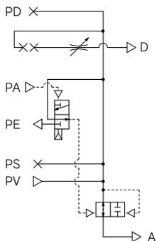
用途: 供給の制御は、外部のエア信号により行います。供給用弁がN.O.タイプですので、停電時に、エジェクタへの供給圧力は停止することがなく、吸着状態を維持します。停電時のワークの落下防止の場合に使用します。破壊はサイレンサとパッドとワーク間の大気の回り込みとなります。破壊の速度を速くする必要のない場合に使用します。
