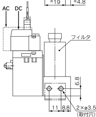
注) パイロット圧供給 (PS) ポートには以下のサイズのワンタッチ管継手またはバープ継手等を用いてください。
