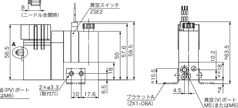
注1) ※寸法はブラケットAの取付時、※※寸法はスぺーサ1の取付時の寸法です。
