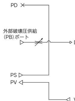
用途：供給の制御は、外部2ポート弁(真空用弁)にて行い、破壊も外部2ポート弁にて行います。
