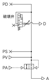
用途: 供給の制御は、外部からのエア信号にて行い、破壊は電磁弁で行います。
