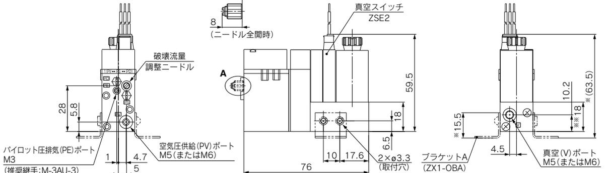
注1) ※寸法はブラケットBの取付時、※寸法はスペース2の取付時の寸法です。
