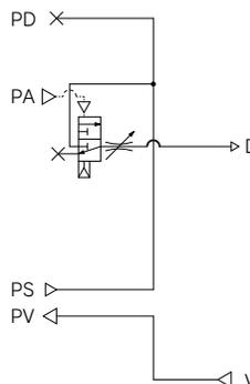
用途：供給の制御は、外部2ポート弁(真空用弁)にて行い、破壊は外部からのエア信号にて行います。
