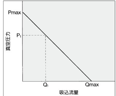
流量特性は、エジェクタの真空圧力と吸込流量の関係を表わし、吸込流量が変化すると真空圧力も変化することを示しています。一般には、エジェクタの標準使用圧力での関係を示しています。
