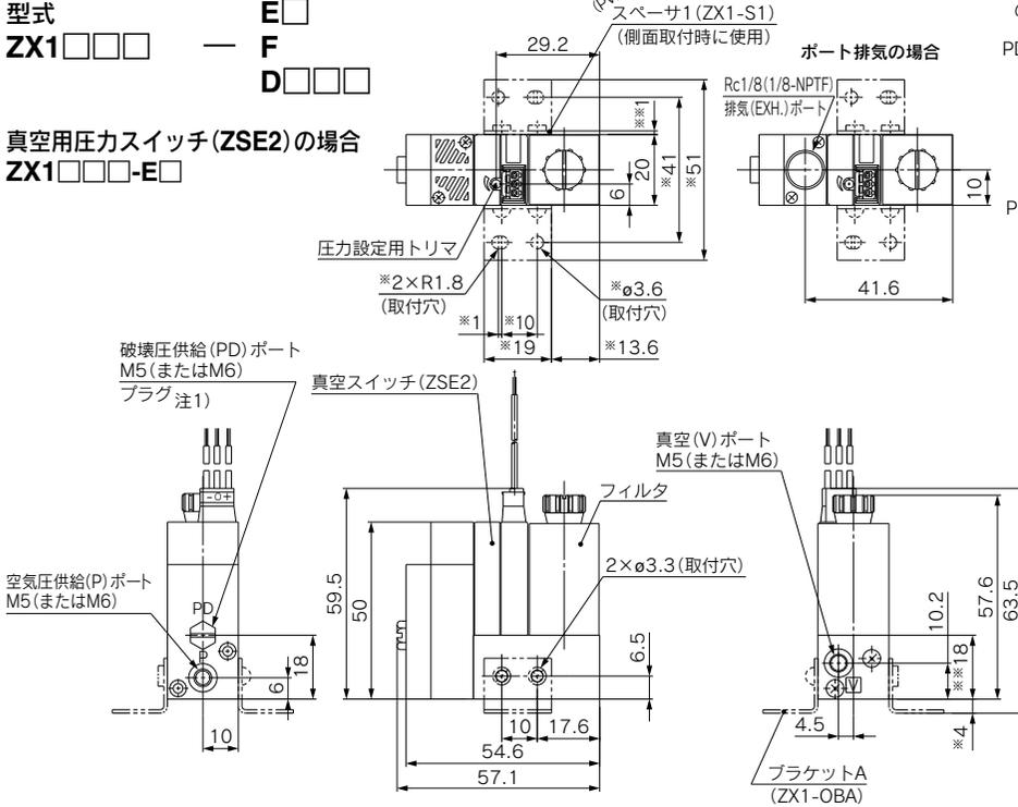
注1) 外部破壊を行う場合プラグを外してください。
