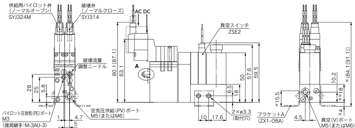
注) ※寸法はプラケットAの取付時、\*\*寸法はスぺーサ1の取付時の寸法です。
