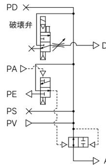
用途: 供給の制御は、外部からのエア信号にて行い、破壊は電磁弁で行います。供給用弁がN.O.タイプですので、停電時に、エジェクタへの供給圧力は停止することがなく、吸着状態を維持します。停電時のワークの落下防止の場合に使用します。
