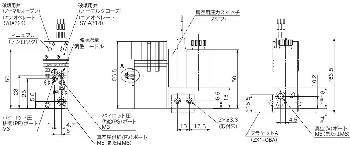
注1) ※寸法はブレットAの取付時、※※寸法はスペーサ1の取付時の寸法です。
