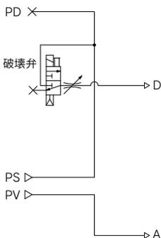
用途: 供給の制御は、外部の弁にて行い、破壊は電磁弁で行います。
