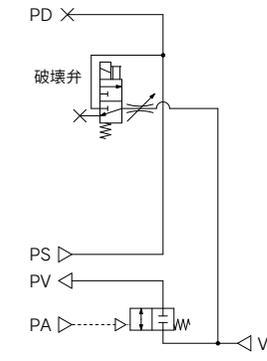
用途:供給の制御は、外部からのエア信号にて行い、破壊は電磁弁で行います。
