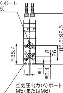
注) ※寸法はブラケットCの取付時、\*\*寸法はスペーサの取付時の寸法です。
