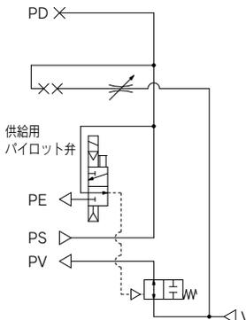
用途:電気信号により、制御する場合に使用します。供給用弁がN.O.タイプですので、停電時に、真空の供給は停止することがなく、吸着状態を維持します。停電時のワークの落下防止の場合に使用します。パッドとワーク間のエアの漏れにより、ワークは離脱しますが漏れの無い場合は、供給用弁をONしても真空保持状態となりワークは離脱しません。破壊を行う場合は、外部に2ポート弁(真空用弁)を設けてください。
