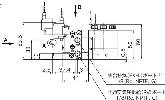
注1) 集合排気(EXH.)ポートはパイロット弁のパイロット圧排気(PE)ポートを兼ねています。大気開放にてご使用願います。
