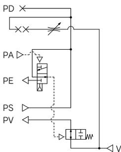
用途：供給の制御は、外部のエア信号により行います。供給用弁がN.O.タイプですので、停電時に、エジェクタへの供給圧力は停止することがなく、吸着状態を維持します。停電時のワークの落下防止の場合に使用します。供給の制御は、外部からのエア信号により行います。パッドとワーク間のエアの漏れにより、ワークは離脱しますが、漏れの無い場合は、供給用弁をONしても真空保持状態となりワークは離脱しません。破壊を行う場合は、外部に2ポート弁を設けてください。
