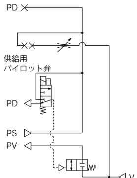
用途:電気信号により、制御する場合に使用します。パッドとワーク間のエアの漏れにより、ワークは離脱しますが漏れの無い場合は、供給用弁をOFFしても真空保持状態となりワークは離脱しません。破壊を行う場合は、外部に2ポート弁(真空用弁)を設けてください。
