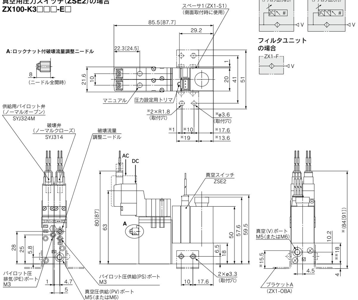
注) ※寸法はプラケットAの取付時、※寸法はスペーサ1の取付時の寸法です。
