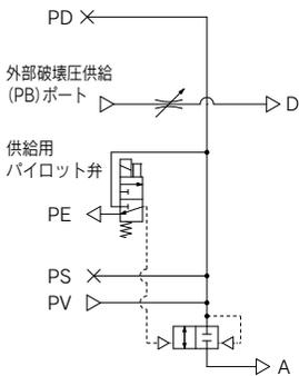
用途: 供給の制御は電気信号で行い、破壊は外部からのエアにて行います。
