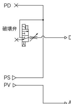
用途: 供給の制御は、外部の弁にて行い、破壊は電磁弁で行います。
