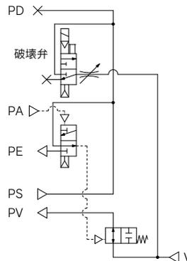
用途:供給の制御は、外部からのエア信号にて行い、破壊は電磁弁で行います。供給用弁がN.O.タイプですので、停電時に、真空供給は停止することがなく、吸着状態を維持します。停電時のワークの落下防止の場合に使用します。
