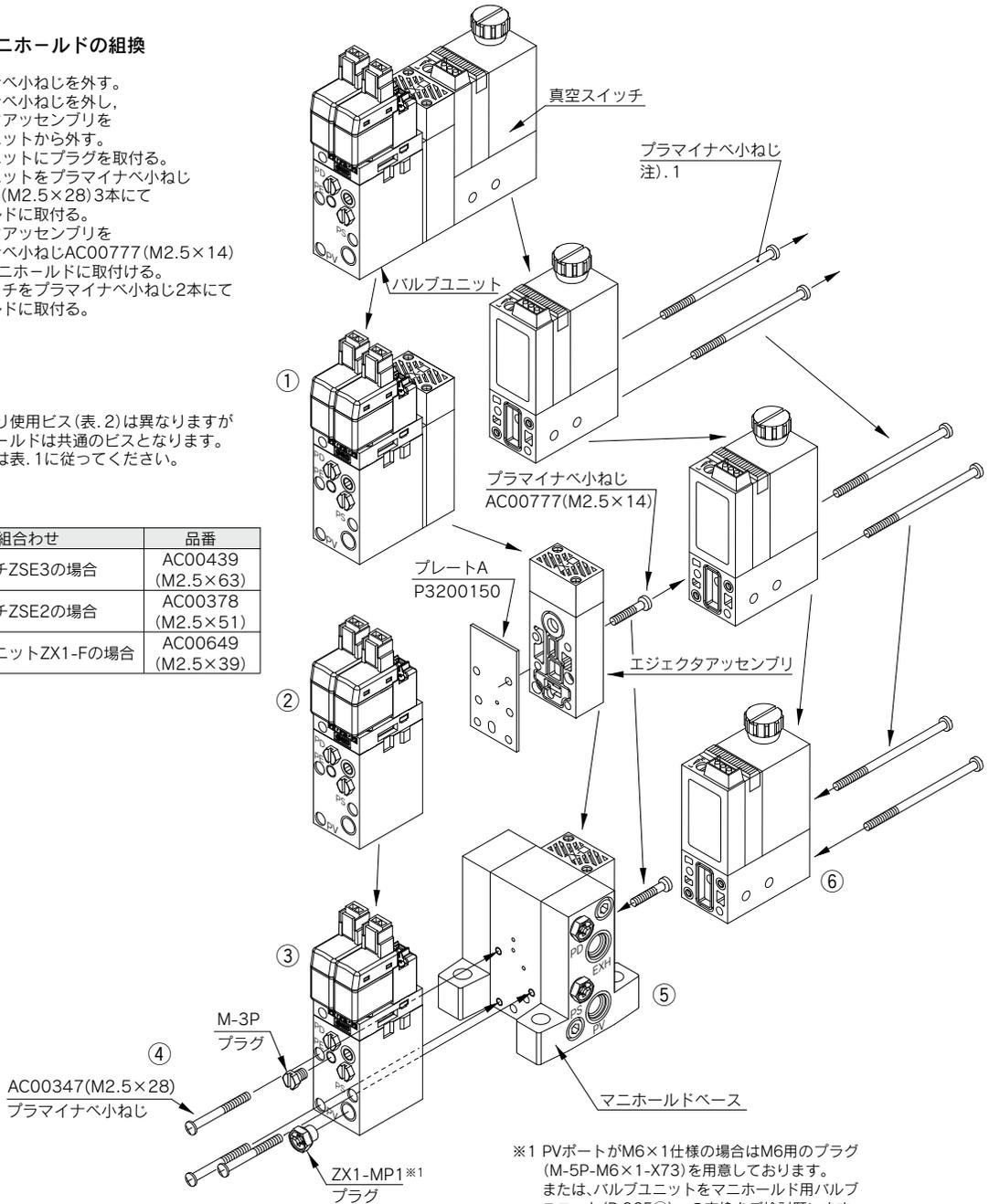
※1 PVポートがM6×1仕様の場合はM6用のプラグ(M-5P-M6×1-X73)を用意しております。または、バルブユニットをマニホールド用バルブユニット(P.925①)への交換をご検討願います。
