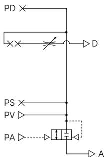
用途: 供給の制御は、外部からのエア信号により行います。破壊はサイレンサとパッドとワーク間の大気の回り込みとなります。破壊の速度を速くする必要のない場合に使用します。
