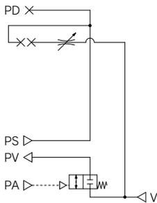
用途：供給の制御は、外部からのエア信号により行います。パッドとワーク間のエアの漏れにより、ワークは離脱しますが、漏れの無い場合は、供給用弁をOFFしても真空保持状態となりワークは離脱しません。破壊を行う場合は、外部に2ポート弁を設けてください。
