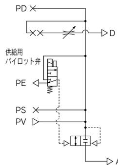
用途: 電気信号により、制御する場合に使用します。破壊はサイレンサとパッドとワーク間の大気の回り込みとなります。破壊の速度を速くする必要のない場合に使用します。
