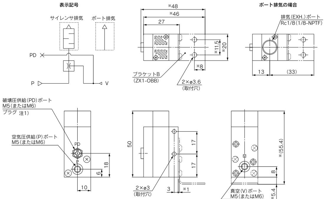
注1) 外部破壊を行う場合プラグを外してください。
