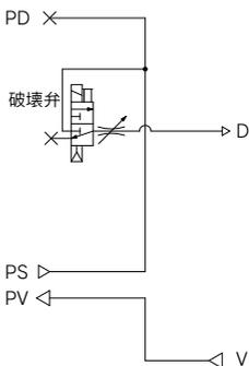
用途：供給の制御は、外部2ポート弁(真空用弁)にて行い、破壊は電磁弁で行います。
