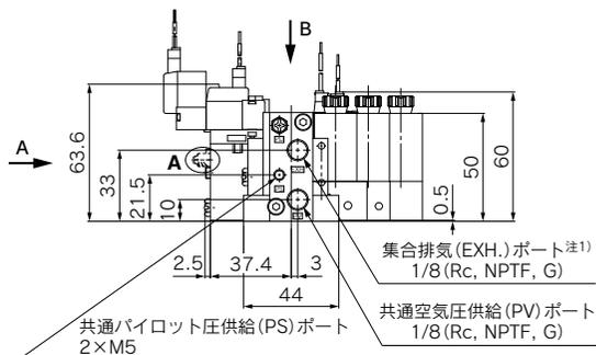
注1) 集合排気 (EXH.) ポートはパイロット弁のパイロット圧排気 (PE) ポートとなっております。大気開放にてご使用願います。
