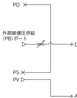
用途: 供給の制御は、外部にて行い、破壊は外部2ポート弁(真空用弁)にて行います。
