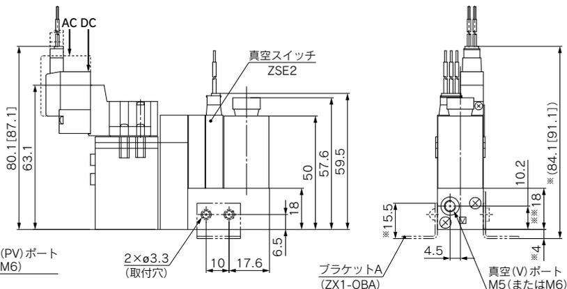
注) ※寸法はブラケットAの取付時、※※寸法はスペース1の取付時の寸法です。
