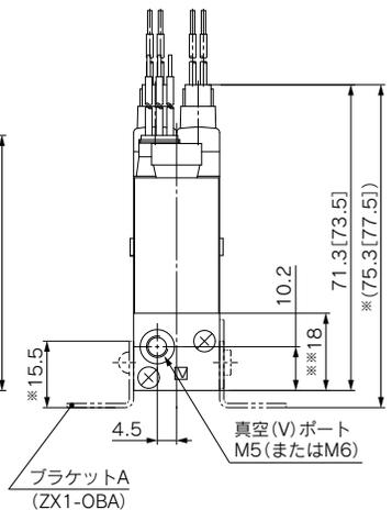
注) ※寸法はブラケットAの取付時、※※寸法はスペーサ1の取付時の寸法です。
