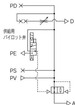
用途: 電気信号により、制御する場合に使用します。供給用弁がN.O.タイプですので、停電時に、エジェクタへの供給圧力は停止することがなく、吸着状態を維持します。停電時のワークの落下防止の場合に使用します。破壊はサイレンサとパッドとワーク間の大気の回り込みとなります。破壊の速度を速くする必要のない場合に使用します。
