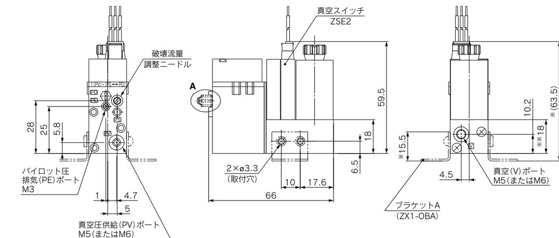
注1) ※寸法はブラケットAの取付時、※※寸法はスペーサ1の取付時の寸法です。
