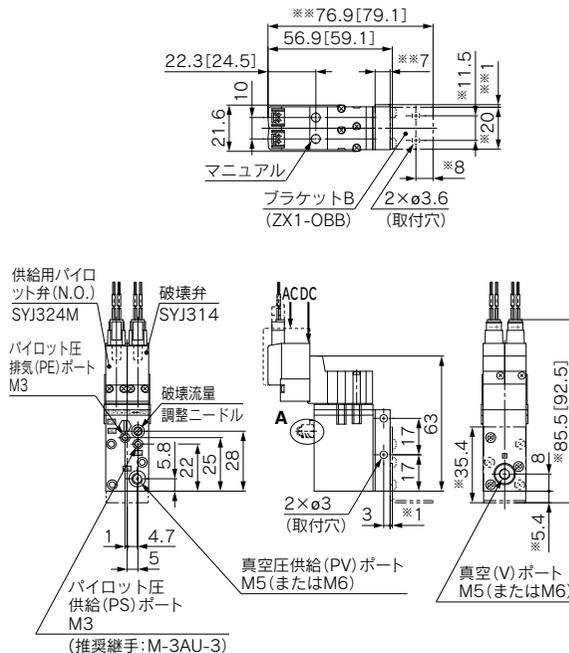
注) ※寸法はブラケットBの取付時、※※寸法はスペーサの取付時の寸法です。
