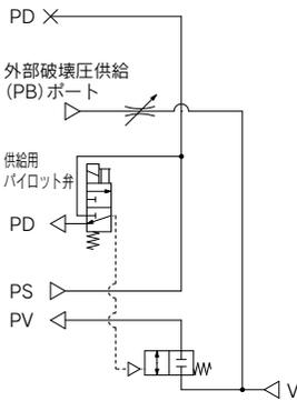
用途:供給の制御は電気信号で行い、破壊は外部からのエアにて行います。
