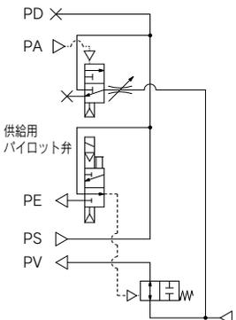
用途:供給の制御は電気信号で行い、破壊はエア信号にて行います。供給用弁がN.O.タイプですので、停電時に、真空供給は停止することがなく、吸着状態を維持します。停電時のワークの落下防止の場合に使用します。
