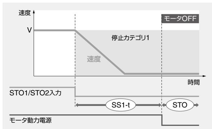
SS1-t動作 : Safe Stop1 / 減速し、規定時間後STO動作
