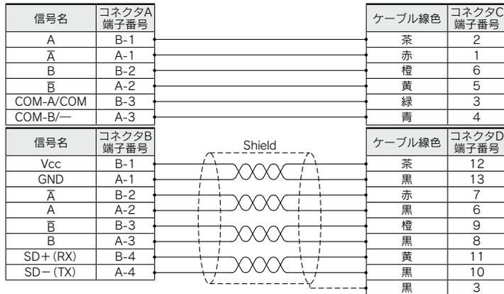
[バッテリーレス アブソ(ステップモータ DC24V)用ロック付口ロボットケーブル]
