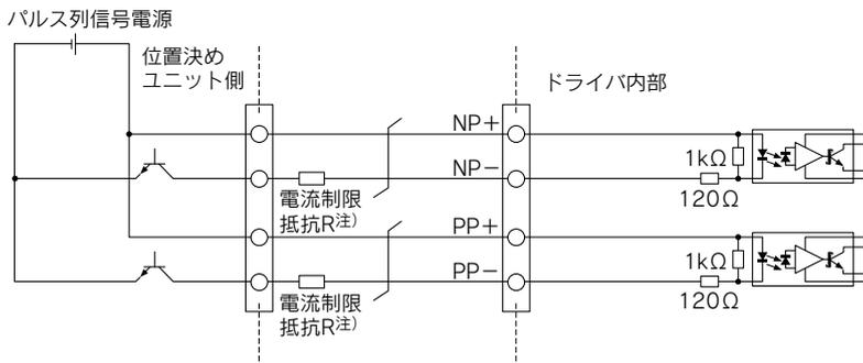
注) パルス列信号の電圧に応じた電流制限抵抗Rを直列に接続してください。
