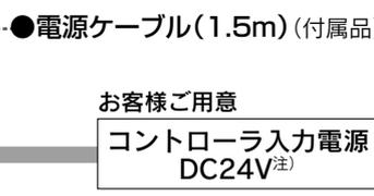
注) ULに適合する場合、組み合わせる直流電源はUL1310に従うclass2電源ユニットをご使用ください。
