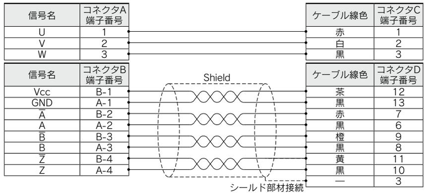
【インクリメンタル(サーボモータ DC24V)用ロック・センサ付ロボットケーブル】
