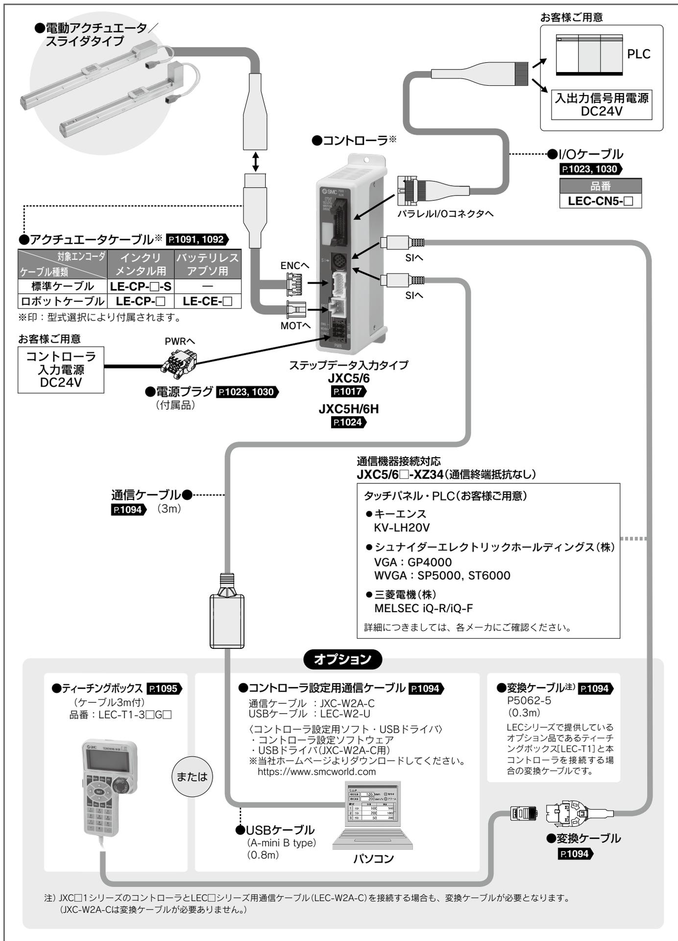
システム構成図／汎用I/O
