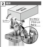
逆方向からワーク衝突時、レバーの動きに 合わせてロックピンがブラケットAss'yか ら外れる。
