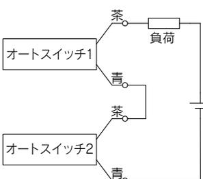
オートスイッチ2個をAND接続した場合ON時の負荷電圧が低下し負荷の作動不良を生じる場合があります。また、表示灯はオートスイッチ2個がON状態となったとき点灯します。負荷電圧仕様が20V未満のオートスイッチは、使用できません。無接点オートスイッチの耐熱型やトリマスイッチをAND接続で使用の際は当社にご確認ください。
